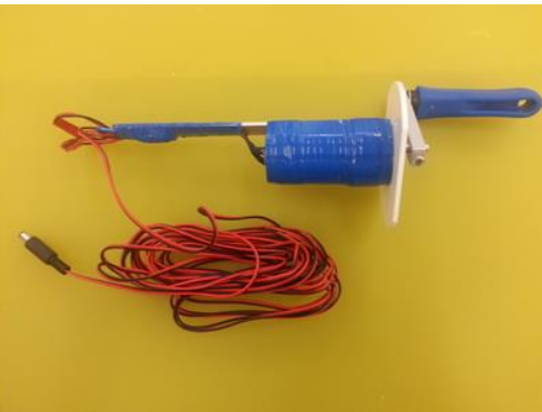
第一種發電裝置：24V 350 rpm 手搖發電機
