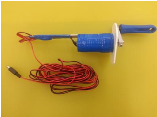
第一種發電裝置：手提式手搖發電機
