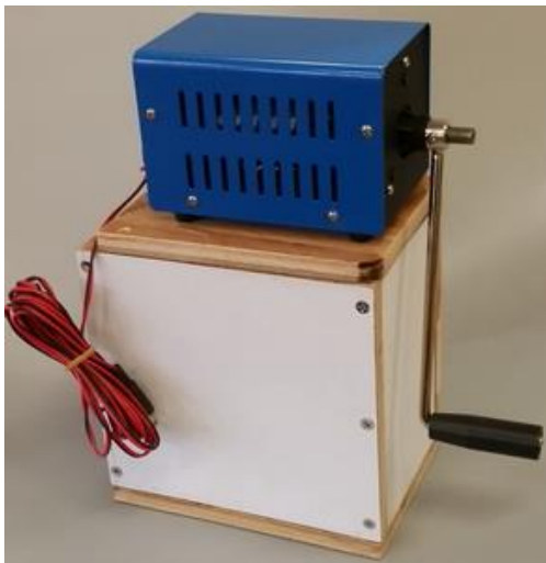
第二種發電裝置：座枱式手搖發電機
