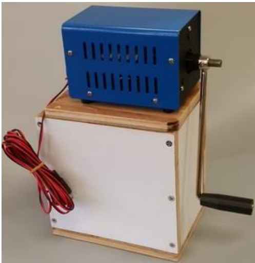
第二種發電裝置：5V 穩壓手搖發電機
